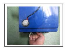
6 カバーを閉めて主電源スイッチを ONにする
